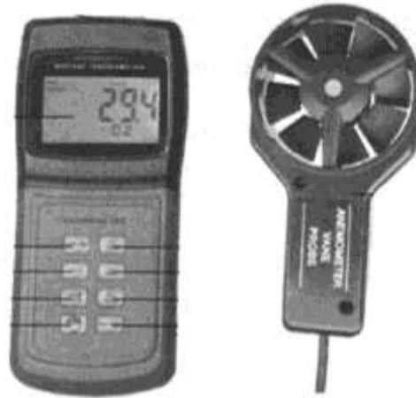
الشكل (1) جهاز قياس الدقائق العالقة لغاية حجم 50 مايكرون مع درجة الحرارة وسرعة الرياح .
